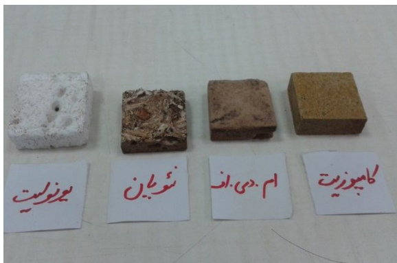
شکل ۳- خسارت و تغذیه موریهانه M. diversus از مواد ساختمانی در آزمون غیرانتخابی
